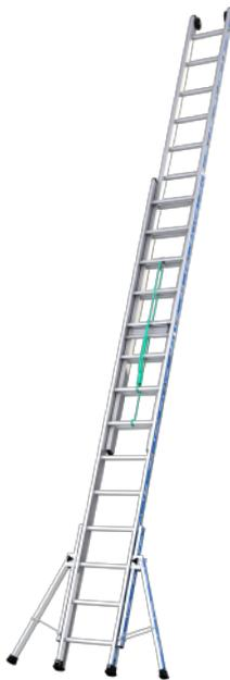
Echelle Platinum 300 Agrip en aluminium coulissante à corde. Sa base stabilisatrice réglable, ses sabots enveloppantshaute sécurité, ses montants extra larges garantissent sécurité et résistance. Montants renforcés. Basculeur d'enclenchement à rappel automatique, pour une mise en place souple et sans effort. Pour usage ultra intensif. Utilisation sur sol plat. Répond aux normes EN 131-6, au décret 96333. Elle est labelisée NF, GS et VGS. Charge maxi 150kg.
